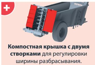
Компостная крышка с двумя створками для регулировки ширины разбрасывания.
